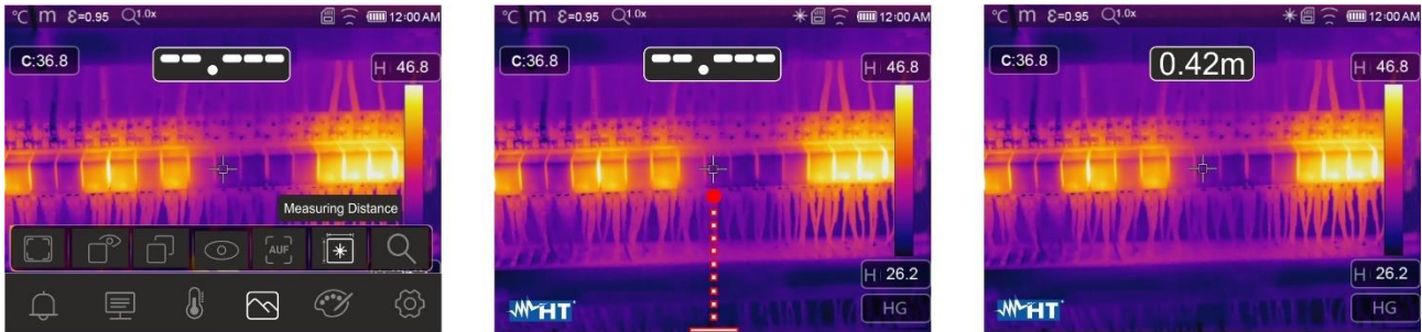
Fig. 38: Función medida de distancia con puntero láser
