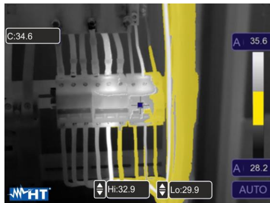
Fig. 43: Selección isoterma Alarm Temp. range
