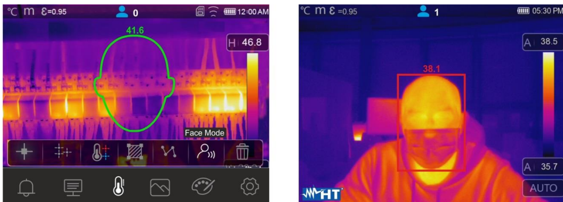
Fig. 54: Visualización condición de alarma en la función Screening
