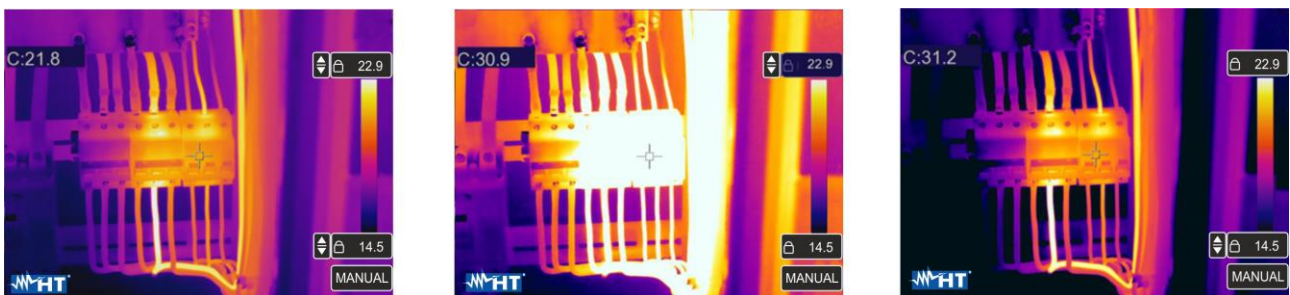
Fig. 47: Configuración modo Manual
