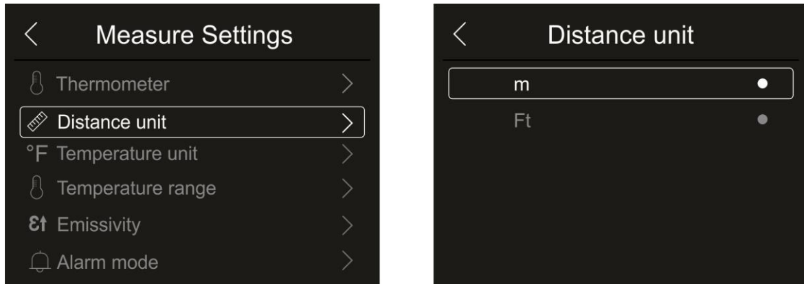
Fig. 25: Menú configuración unidad medida de distancia
