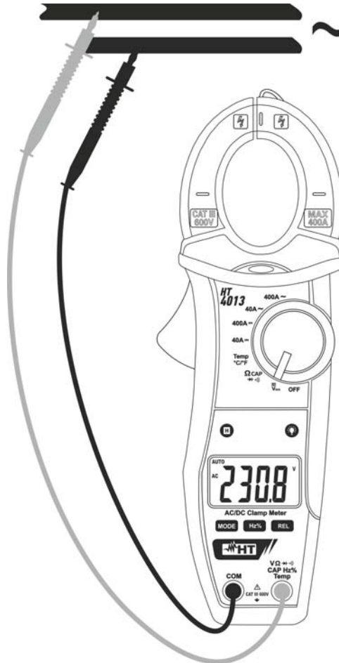
Fig. 4: Uso de la pinza en medida de Tensión CA
