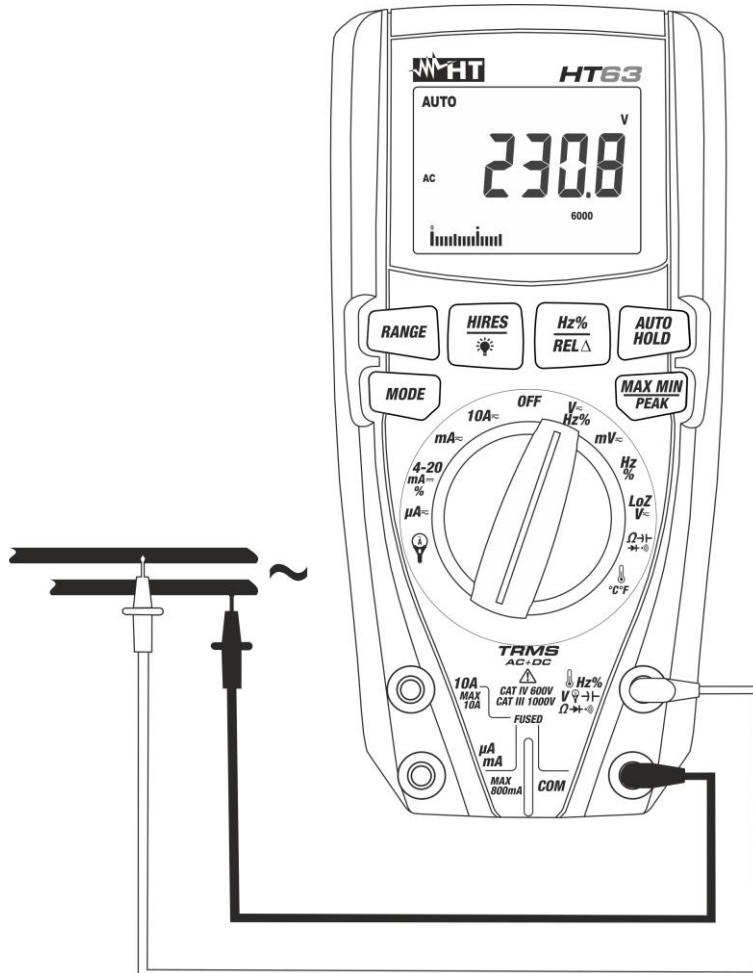
Abb. 3: Verwendung des Gerätes für Wechselspannungsmessung
