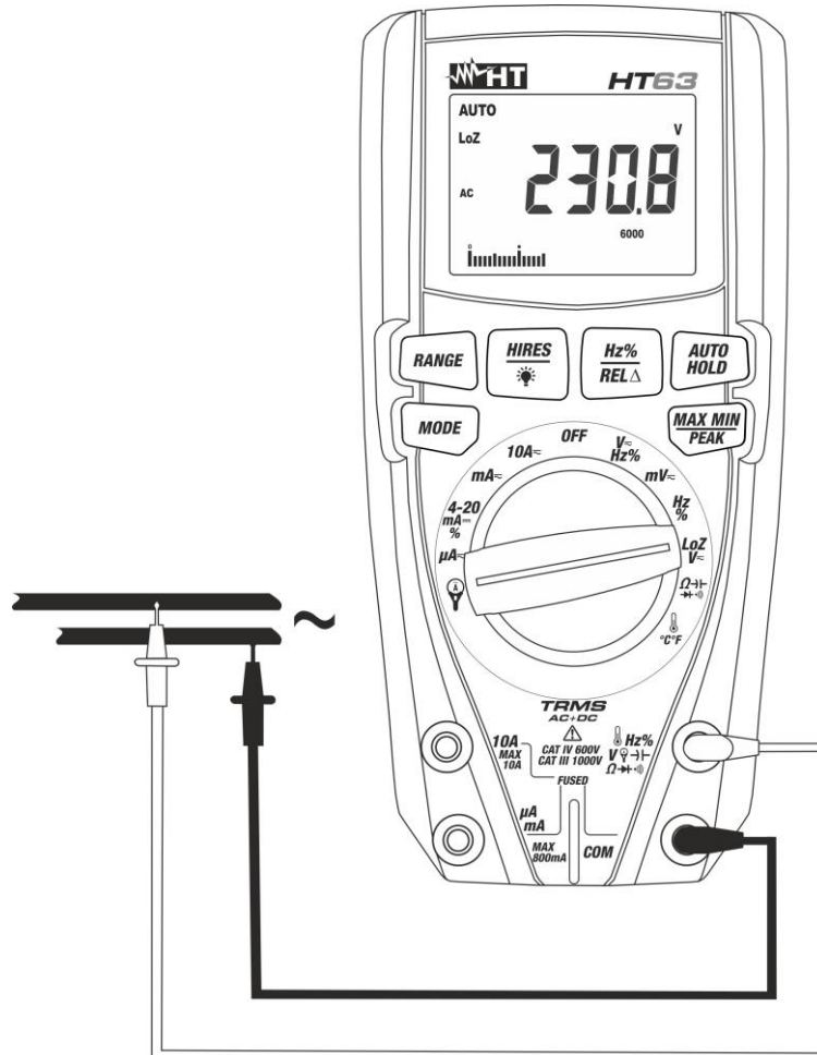
Abb. 4: Verwendung des Gerätes für Spannungsmessung mit niedriger Impedanz (LoZ)
