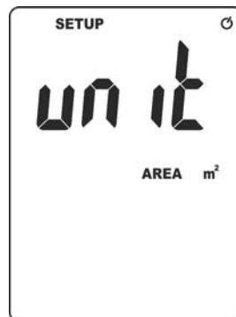
Fig. 3: Configuración unidad de medida área del conducto
