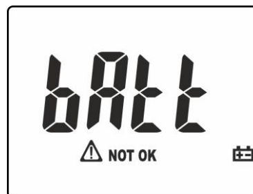
Fig. 43: Pantalla con indicación pilas descargadas
