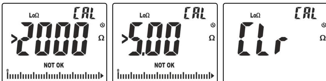
Fig. 35: Puesta a cero de una calibración
