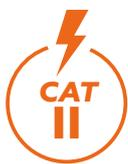
Mediciones realizadas en circuitos conectados directamente a la instalación a baja tensión
