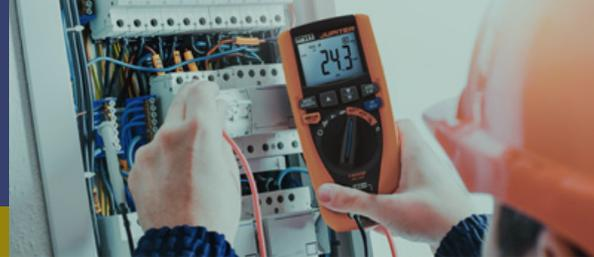
En el ámbito de las instalaciones residenciales, la norma CEI 64 8 exige que se lleven a cabo ciertas comprobaciones para certificar que el sistema ha sido construido de manera profesional. Además de los instrumentos clásicos para la detección de tensión y corriente, HT ITALIA dispone de instrumentos sencillos y portátiles para las mediciones clásicas de tierra, diferencial y aislamiento.
